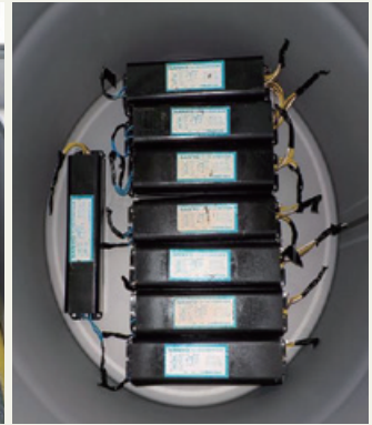
高濃度PCB廃棄物(蛍光灯安定器)
